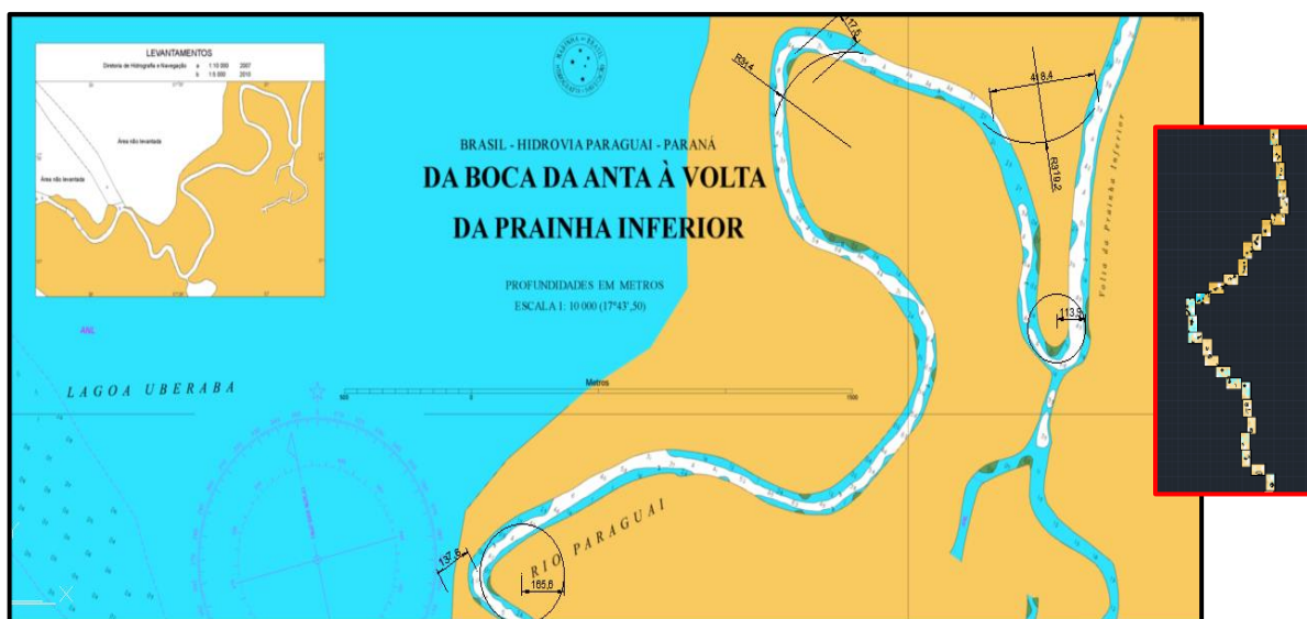
Figura 14 - Colocação à escala das cartas batimétricas e levantamento – método gráfico
